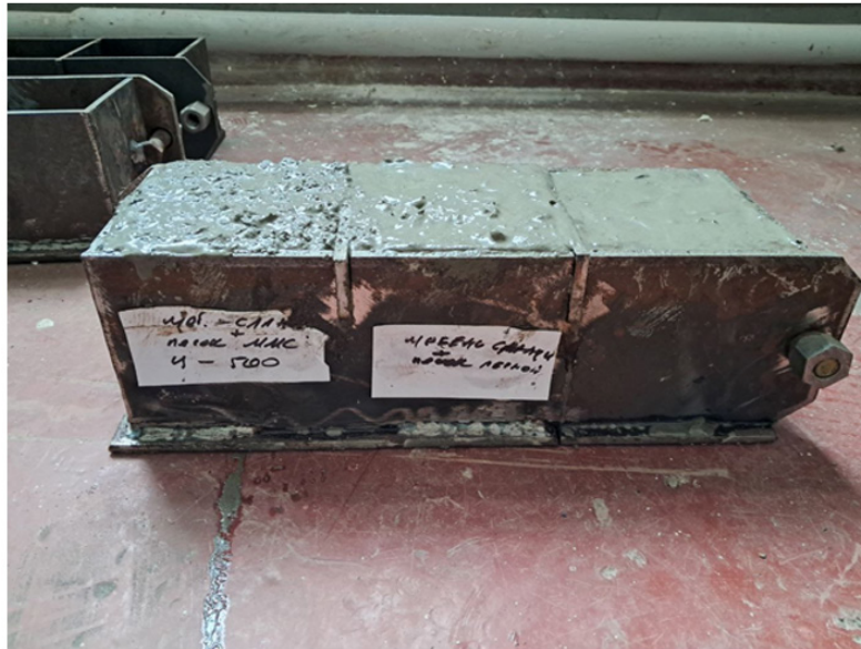
Рис. 2. Форма для кубів стандартного розміру 150 \times 150 \times 150 мм Джерело: сформовано авторами
