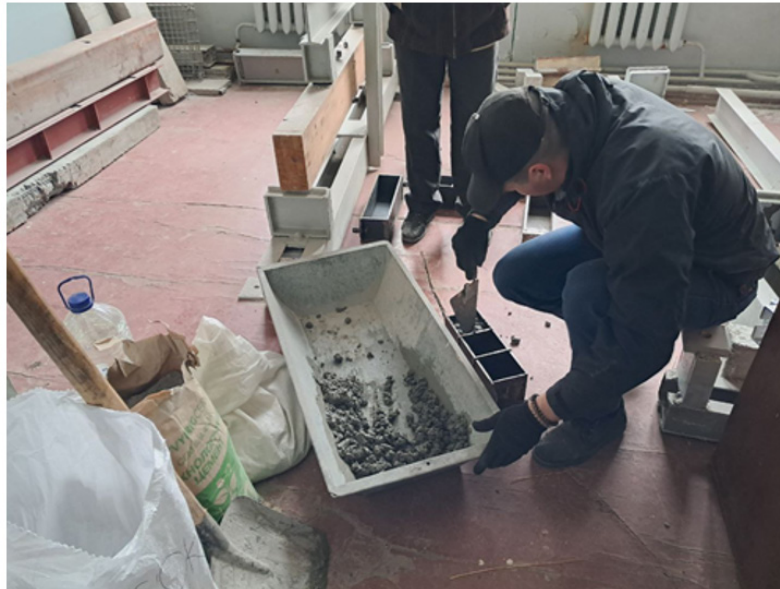
Рис. 1. Завантаження бетонної суміші у форми Джерело: сформовано авторами
