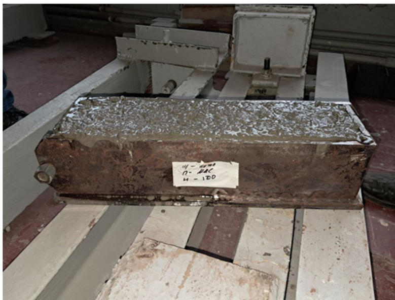
Рис. 3. Форма для призми стандартного розміру 150 \times 150 \times 600 мм Джерело: сформовано авторами
