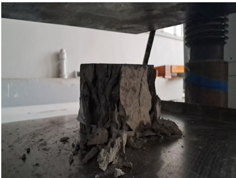
Рис. 4. Проведення експерименту з кубами Джерело: сформовано авторами
